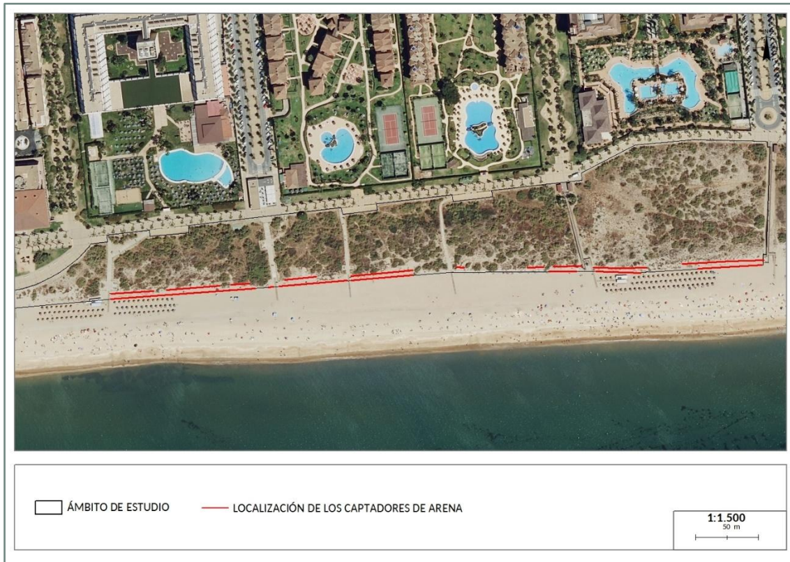
Ilustración 22: Instalación de captadores de arena en la mitad oriental del ámbito de estudio.
