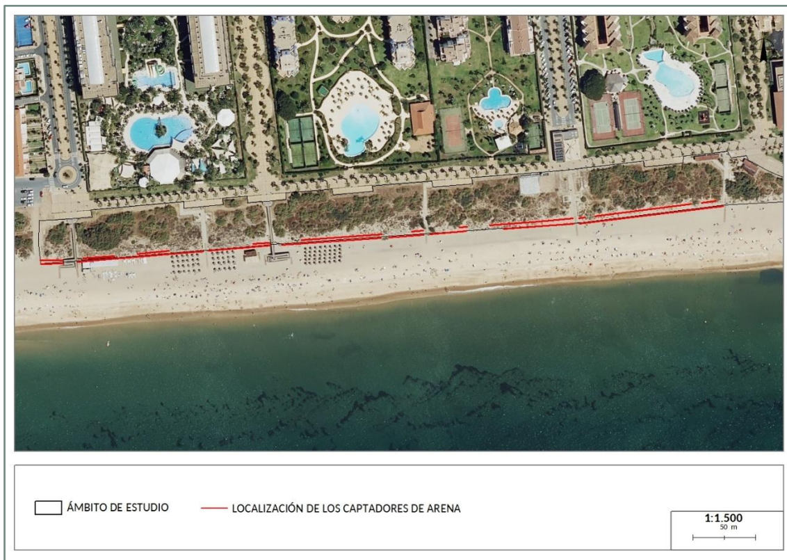
Ilustración 21: Instalación de captadores de arena en la mitad occidental del ámbito de estudio.
